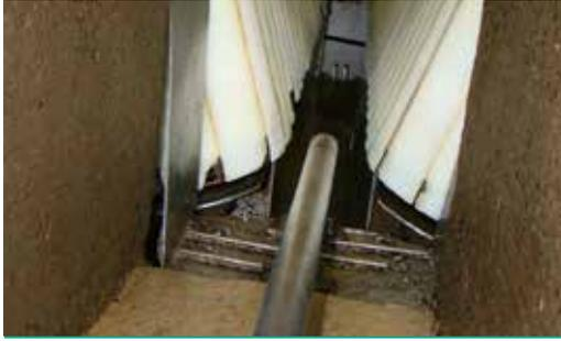
Figura 22. Suínos tem dificuldade para entrar no *restrainer* e ser insensibilizado, principalmente quando há mudanças de cor e ausência de fundo falso.
