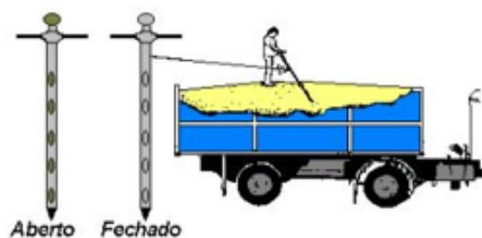
Figura 2. Calador e processo de coleta de amostras
